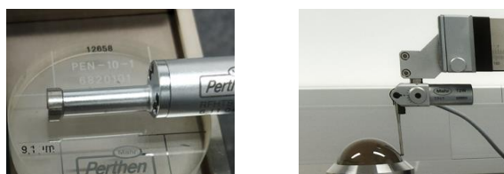
Figure 1. Máquina de defeito de forma e de rugosidades (foto IPQ) com sondas de contacto para caracterização de forma das superfícies e determinação dos parâmetros de rugosidade.
